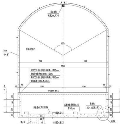
实验设备基坑设计图 (华东设计院)
